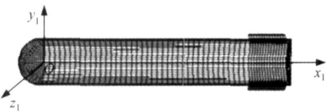
图 11 母弹网格模型 Fig. 11 Mesh model of cargo projectile
